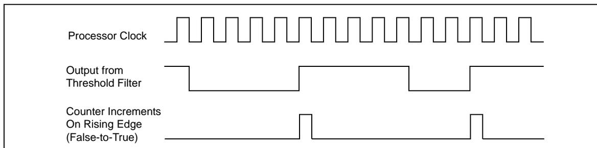
**Figure 18-38. Effects of Edge Filtering**
