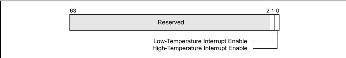
Figure 14-9. IA32\_THERM\_INTERRUPT MSR
