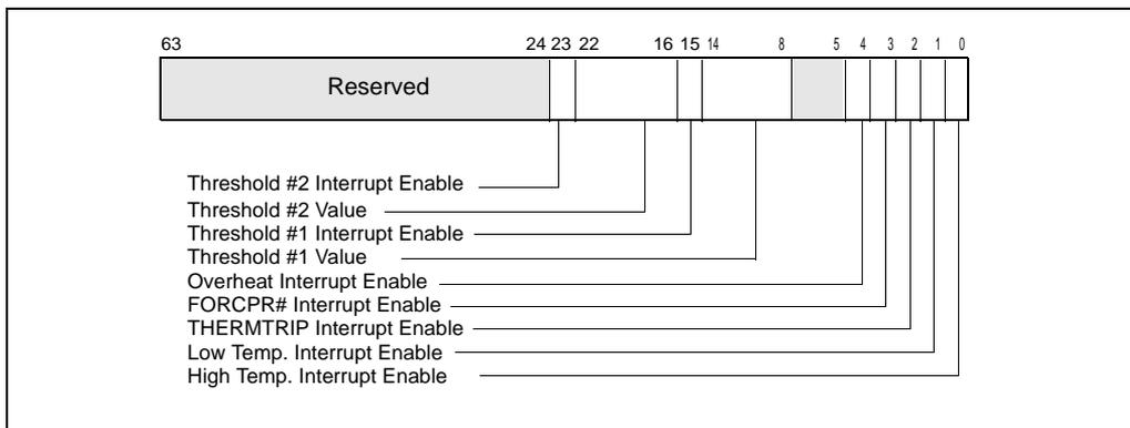
**Figure 13-9. IA32\_THERM\_INTERRUPT Register**
