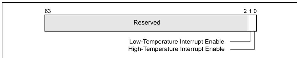
Figure 13-6. IA32\_THERM\_INTERRUPT MSR
