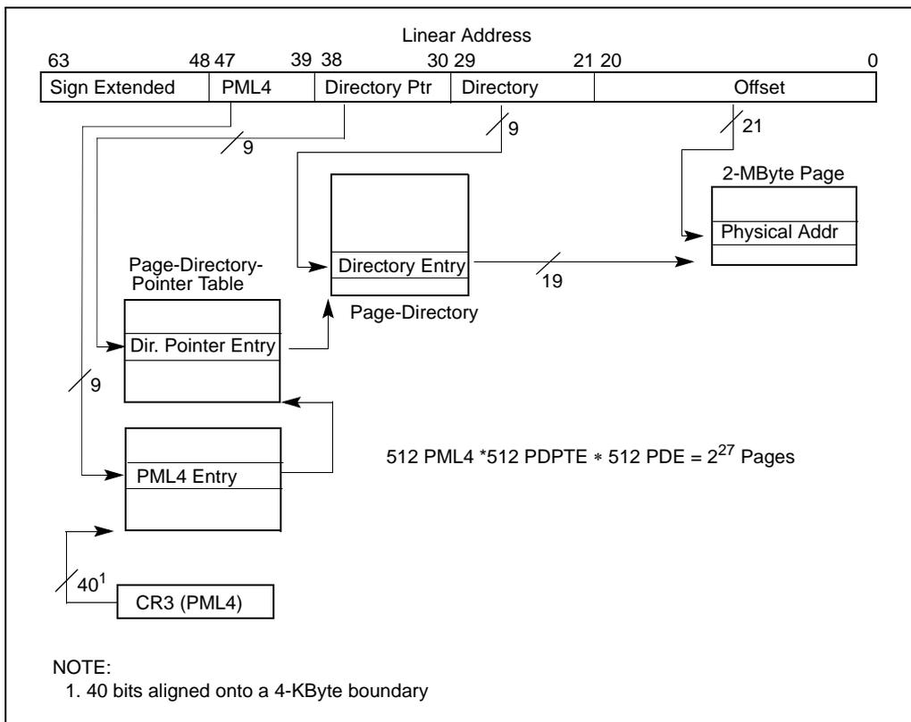
Figure 3-25. IA-32e Mode Paging Structures (2-MByte pages)
