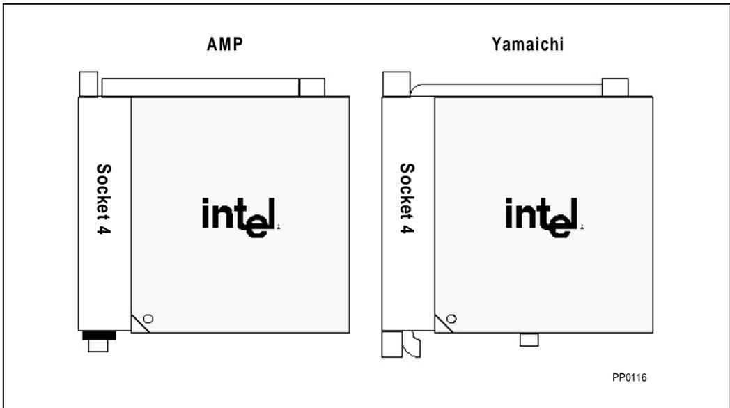
**Figure 16-2. Socket 4 Chip Orientation**
