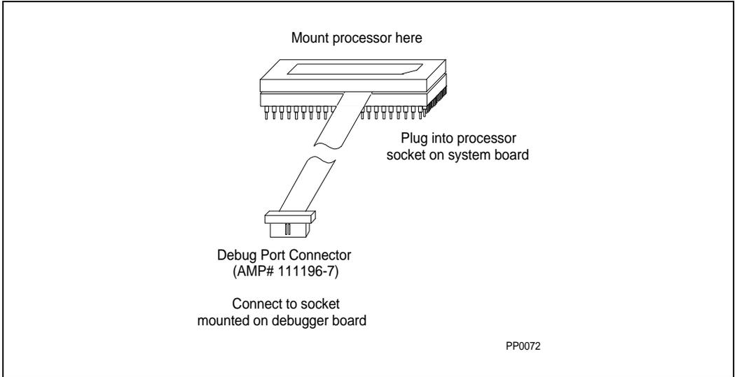
**Figure 31-8. Uni-Processor Debug**
